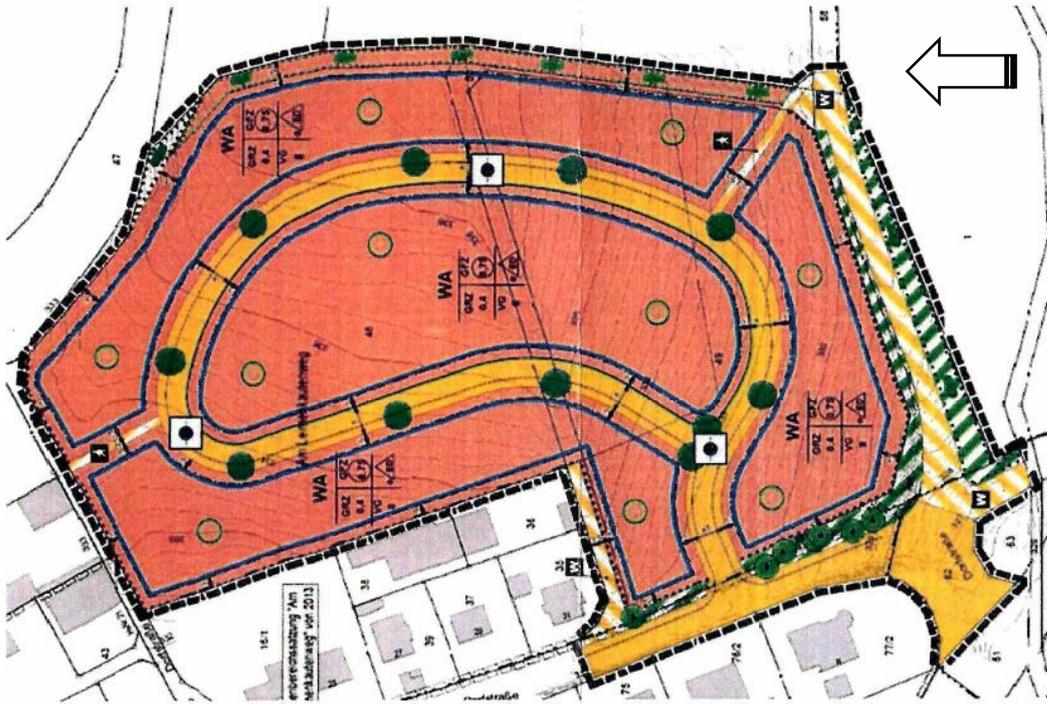
Abbildung 5: Empfehlung zur Anordnung von Standorten für Hydranten
