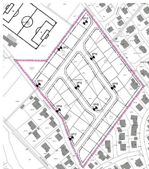
**Abb. 2: Lage der Immissionsaufpunkte IP1 – IP9 für die Einzelpunktberechnung**
