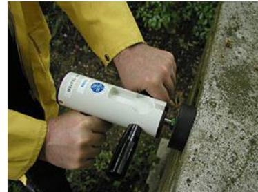
Die Standsicherheitsprüfung wird mit Hilfe eines Grabstein-Kipptesters durchgeführt. Die Prüfung dauert damit etwa 30 Sekunden. Wenn der Grabstein einen Druck von 30 Kilo standhält (wird durch das Gerät angezeigt) steht der Grabstein sicher. Eine Einstufung in „nicht standsicher“ erfolgt bei allen Grabmalen, die bei Aufbringen der Prüflast deutliche
