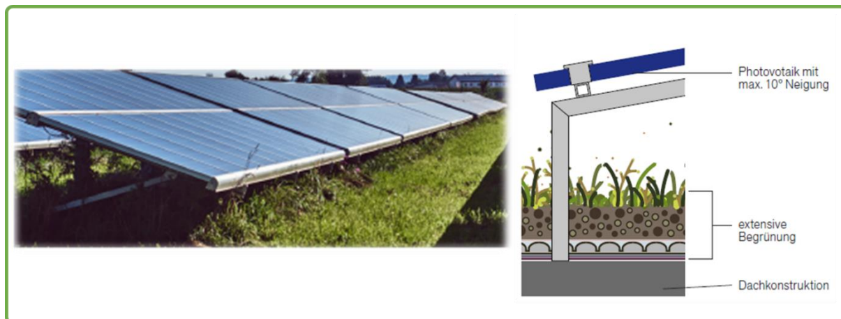
Abbildung 90: Photovoltaik mit Dachbegrünung 333
