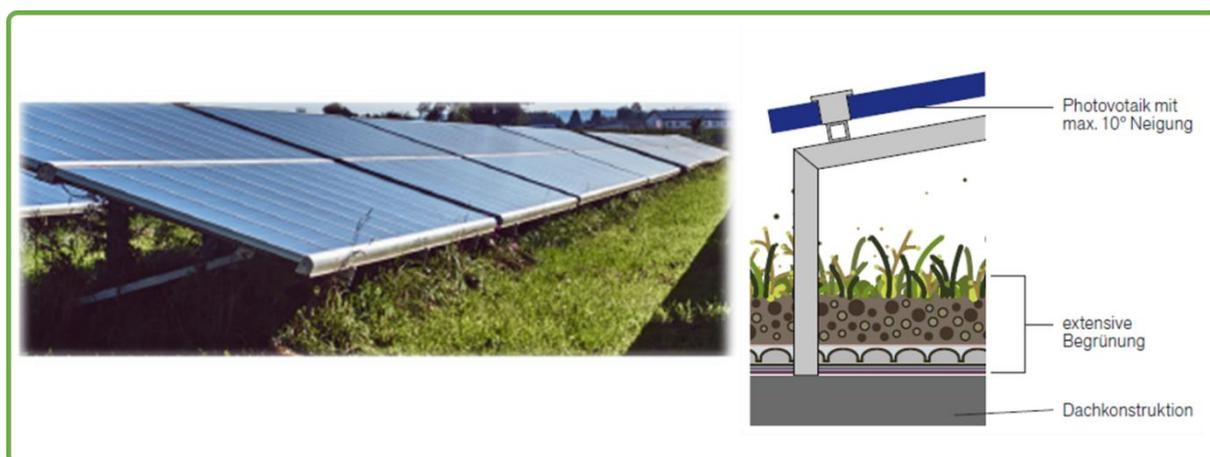
Abbildung 90: Photovoltaik mit Dachbegrünung<sup>333</sup>
